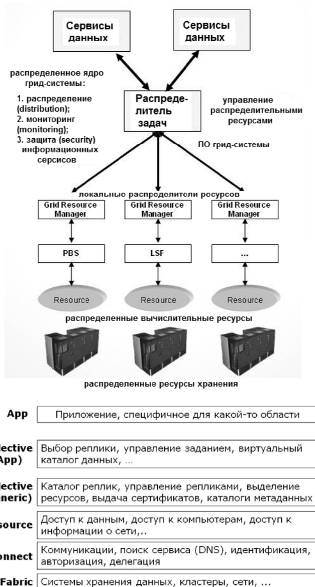
Рис. 7. Структура и количество сервисов распределенной Grid-системы
