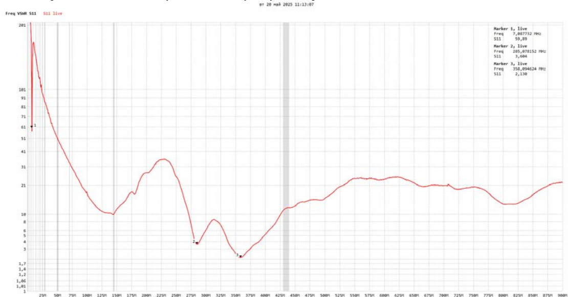
Рисунок 11 – Зміна SWR генератора хаосу в діапазоні частот від 15 кГц до 1 ГГц
