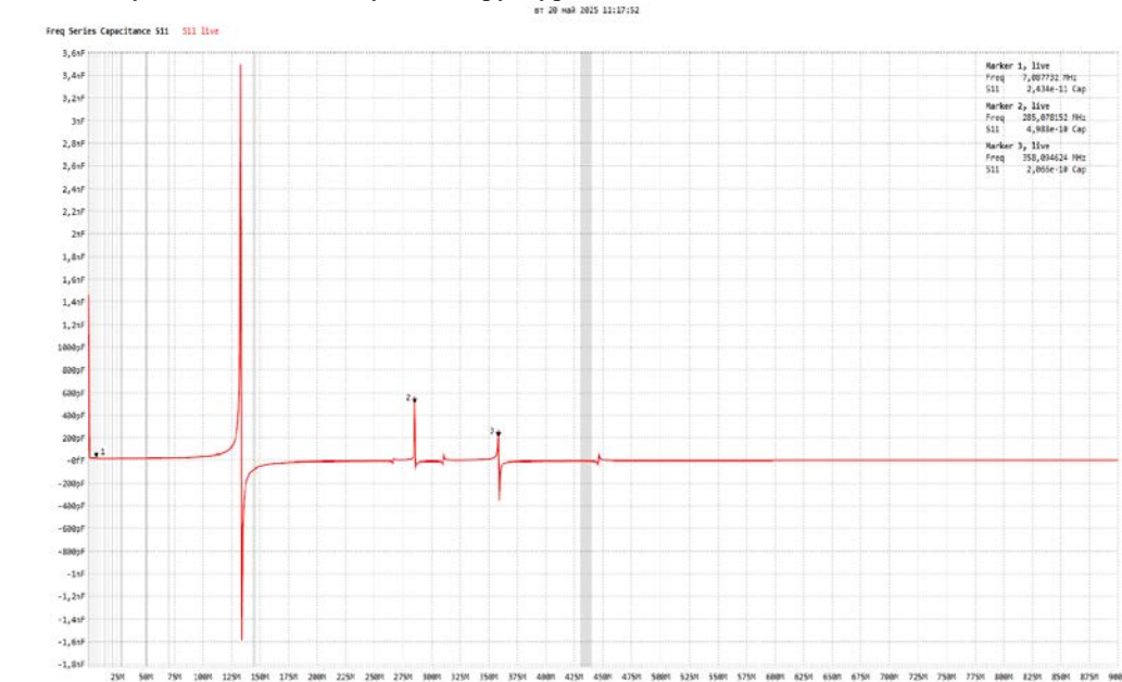
Рисунок 8 – Зміна прохідної ємності генератора хаосу в діапазоні частот від 15 кГц до 1 ГГц
