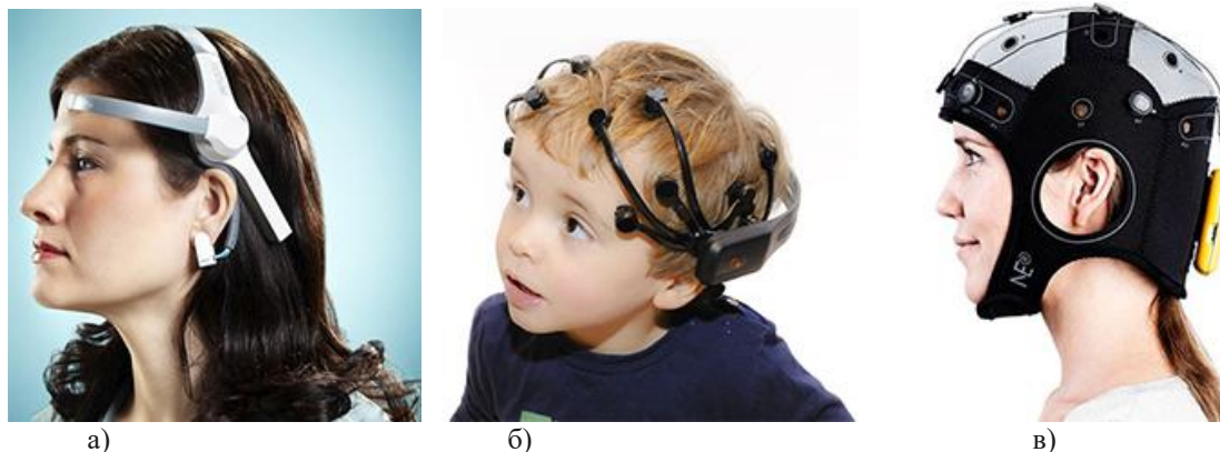
Рисунок 1 – Зовнішній вигляд гарнітур: а – споживчого класу; б – лабораторного рівня; в - професійна або лабораторна ЕЕГ гарнітура для досліджень
