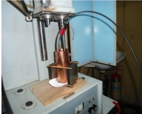
Рисунок 5 – Зовнішній вигляд генератора ультразвуку та циліндричного електромагнітного екрану, всередині якого встановлено посудину з колоїдним розчином магнітних наночастинок
