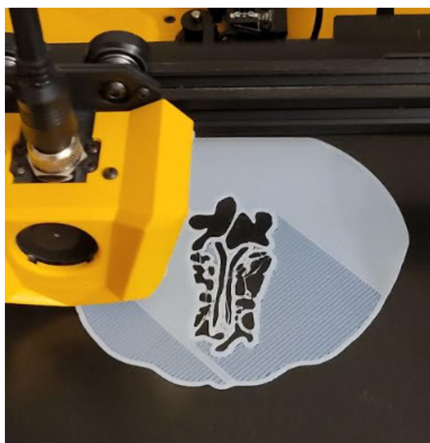
Рисунок 7 – Завершальний етап друку моделі томографічного зрізу з рисунку 5
