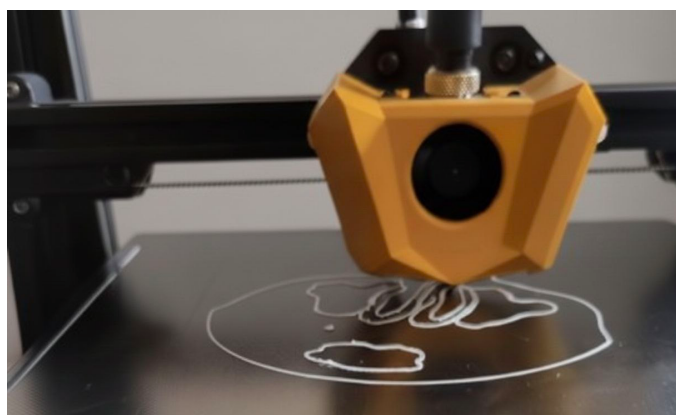
Рисунок 6 – Початок прототипування моделі зрізу носової порожнини на етапі друку стартового шару з відображенням обмежуючої області друку
