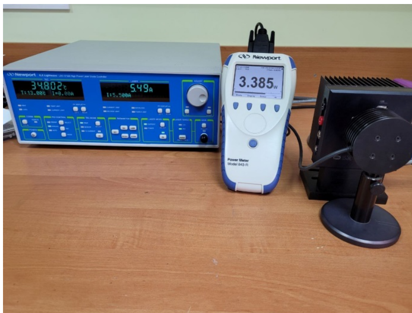
Рисунок 1 – Фотографія експериментальної установки: контролер струму NEWPORT LDC-37620, TEC-модуль стабілізації та оптична вимірвальна система NEWPORT Power Meter Model B43-R.
