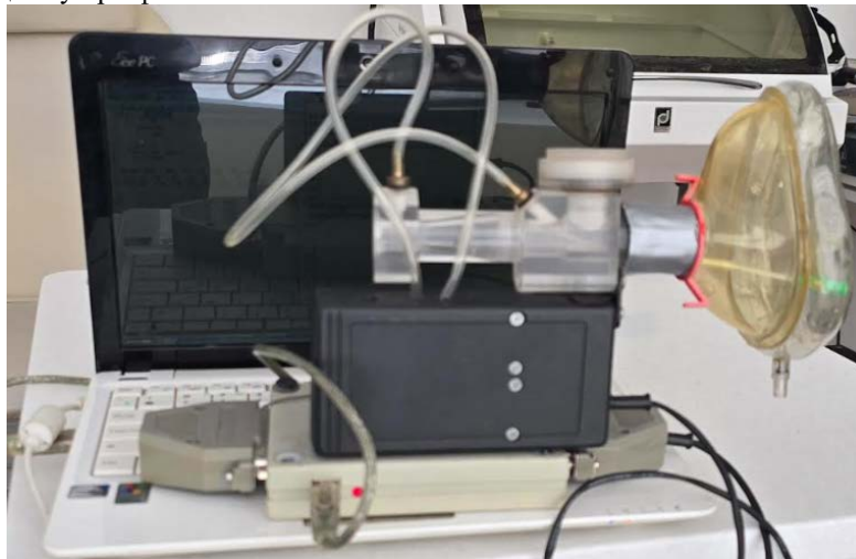
Рисунок 2 – Комп'ютерний риноманометр для тестування носового дихання на основі пристрою для вимірювання перепадно-витратних характеристик КРМ ТНДА-ПВХ
