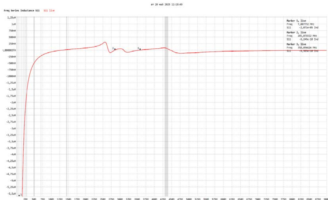
Рисунок 9 – Зміна індуктивності генератора хаосу в діапазоні частот від 15 кГц до 1 ГГц
