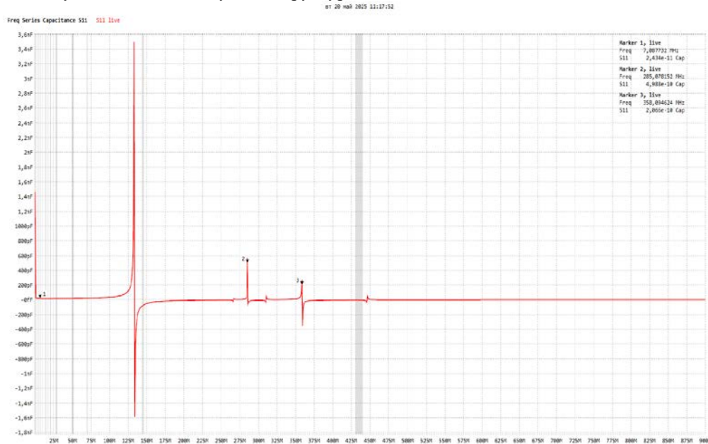
Рисунок 8 – Зміна прохідної ємності генератора хаосу в діапазоні частот від 15 кГц до 1 ГГц
