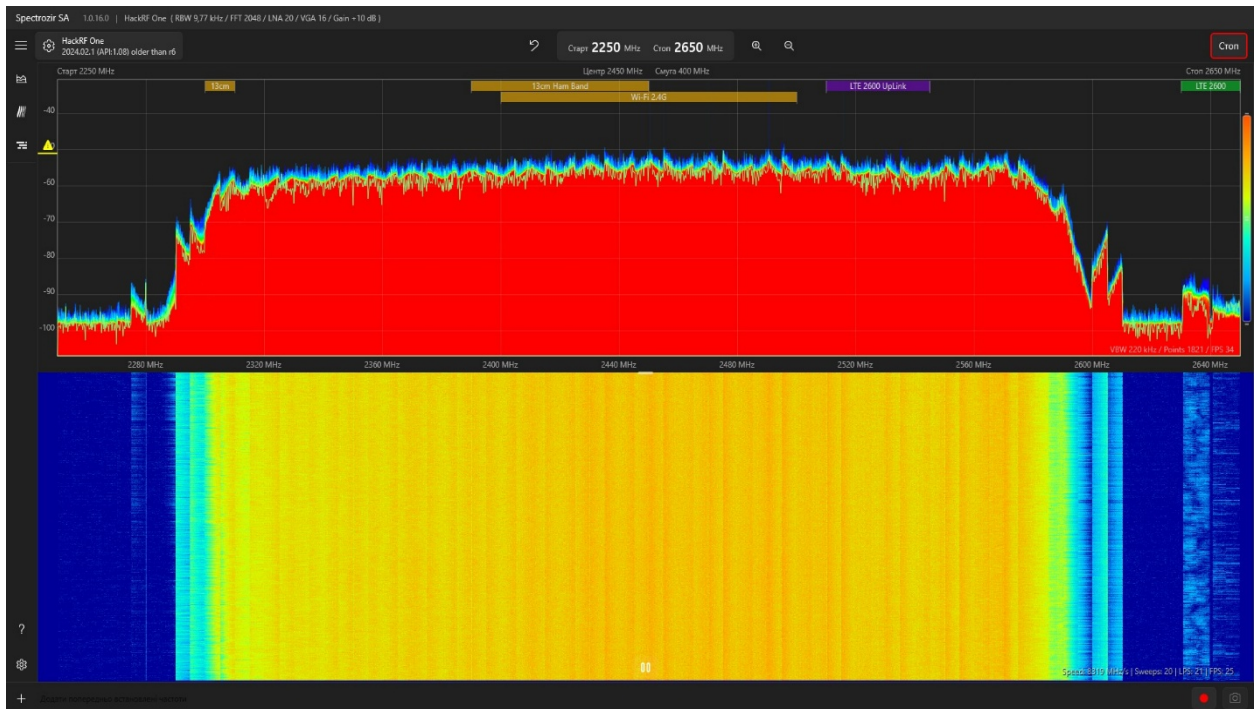
Рисунок 13 – Спектр вихідного сигналу пристрою передавання на основі генератора хаосу в діапазоні від 2,3 ГГц до 2,55 ГГц
